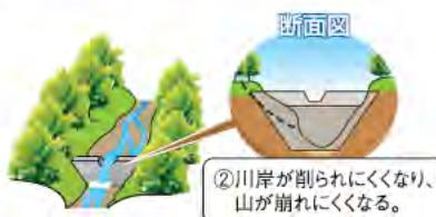
③砂防堰堤が土砂でいっぱいになっていても、次にたくさんの土砂が流れでてきたとき、傾きのゆるやかな広場が勢いを弱め、土砂を散らして止めることもできます。
