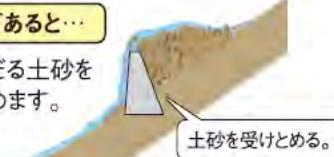
急な川の傾きをゆるやかにし、土砂のスピードを小さくして、川岸がけずられ、山が崩れるのをおさえます。
