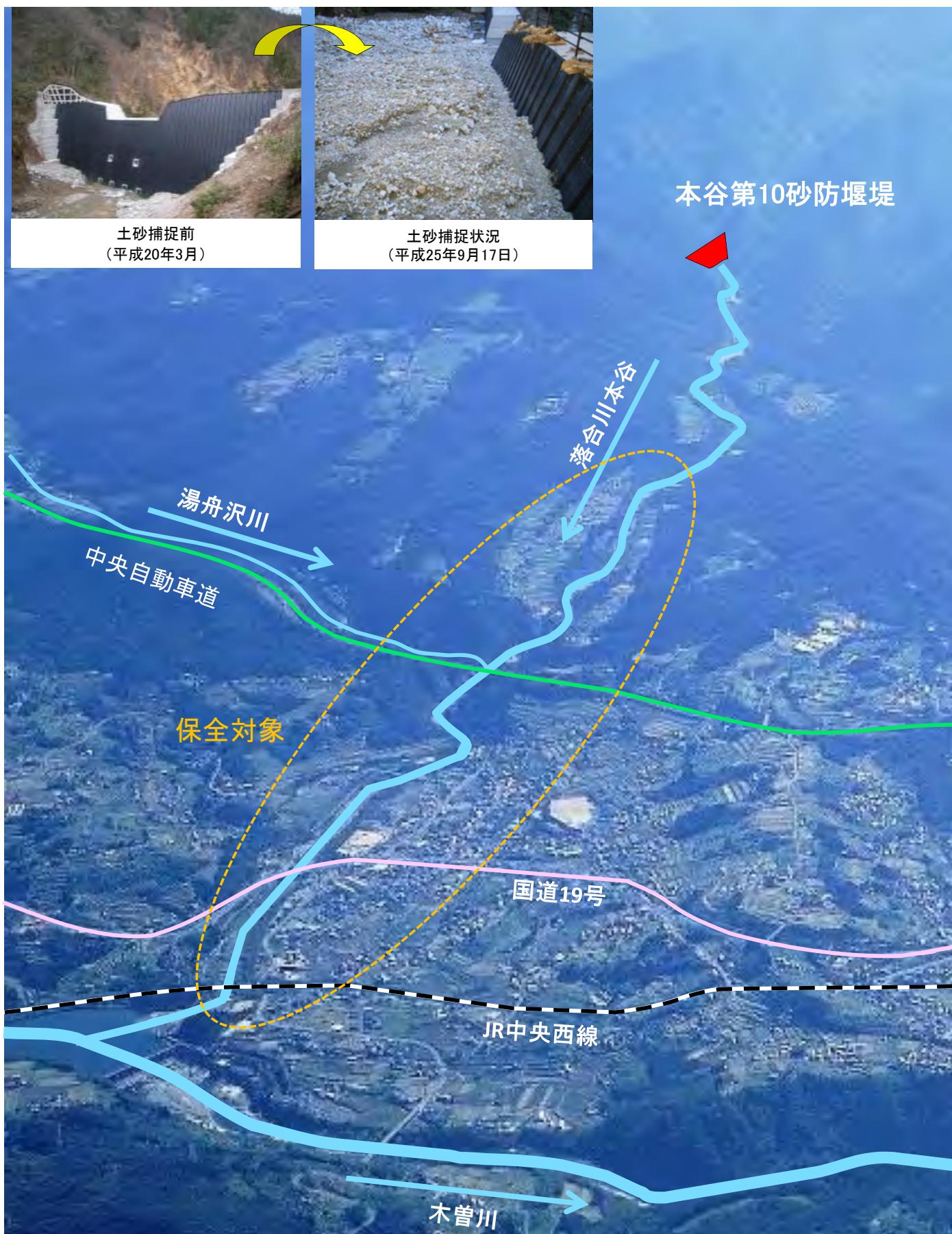
平成25年9月16日、台風18号に伴う流出土砂約59,000m<sup>3</sup>を落合川本谷第10砂防堰堤で捕捉しました。本谷第10砂防堰堤が多量の土砂を捕捉したことにより、下流河道は埋塞を免れ、人家や国道19号などに対する被害を未然に防ぎました。
