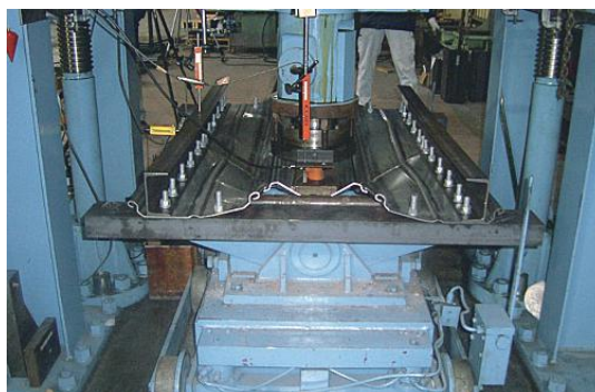
上流外部保護材の各種試験状況（左写真；実物大衝撃試験、右写真；載荷試験）
