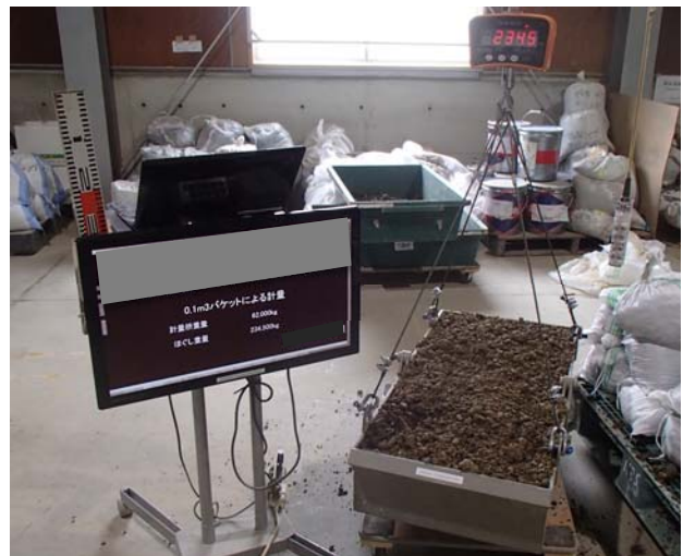
写真- 5.7 試験試料の土砂容積変化率測定状況 （締固め前の 0.1\text{m}^3 重量を測定し、最大乾燥密度との比率を計算する）
