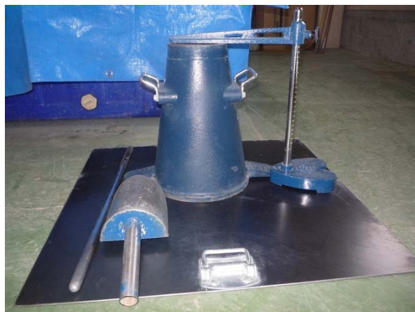
写真- 5.6 コンクリート用スランプ測定機器
