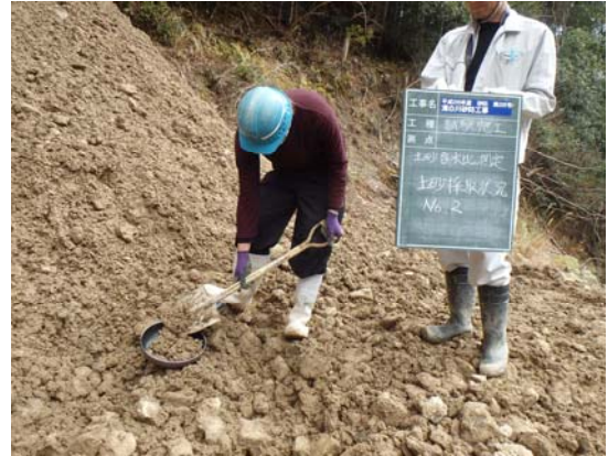
写真- 4.9 含水比測定用試料の採取状況
