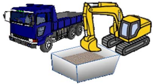
図-4.4 単設混合機概念図
