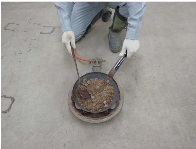
写真- 4.10 含水比測定（左：フライパン法・右：電子レンジ法）
