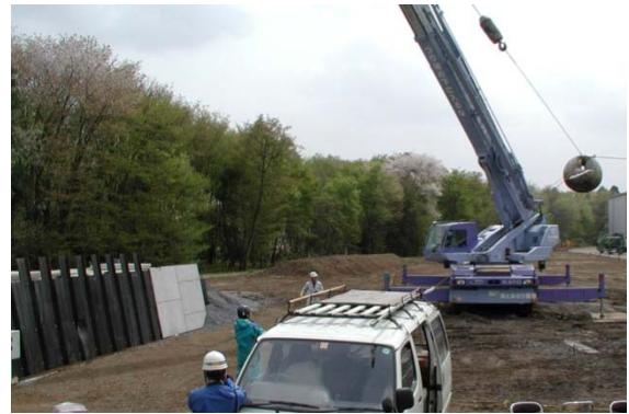
写真- 3.5 衝撃試験状況（振り子方式）
