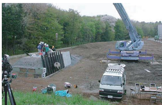
上流外部保護材の各種試験状況（左写真；実物大衝撃試験、右写真；載荷試験）
