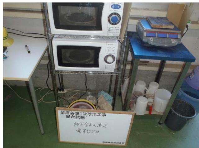
写真-4.6 含水比測定（左：フライパン法・右：電子レンジ法）
