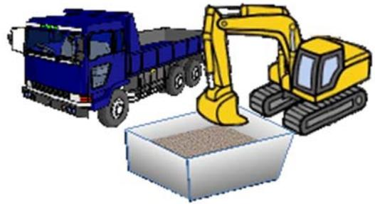
図-4.4 単設混合柵の概念図
