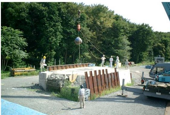
写真- 3.2 衝撃実験状況(自由落下方式)
