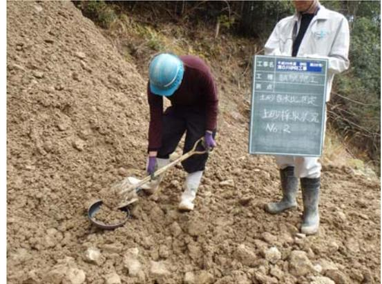
写真-4.5 含水比測定用試料の採取状況
