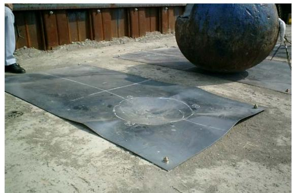
写真- 3.3 衝撃実験後の鋼板の状況
