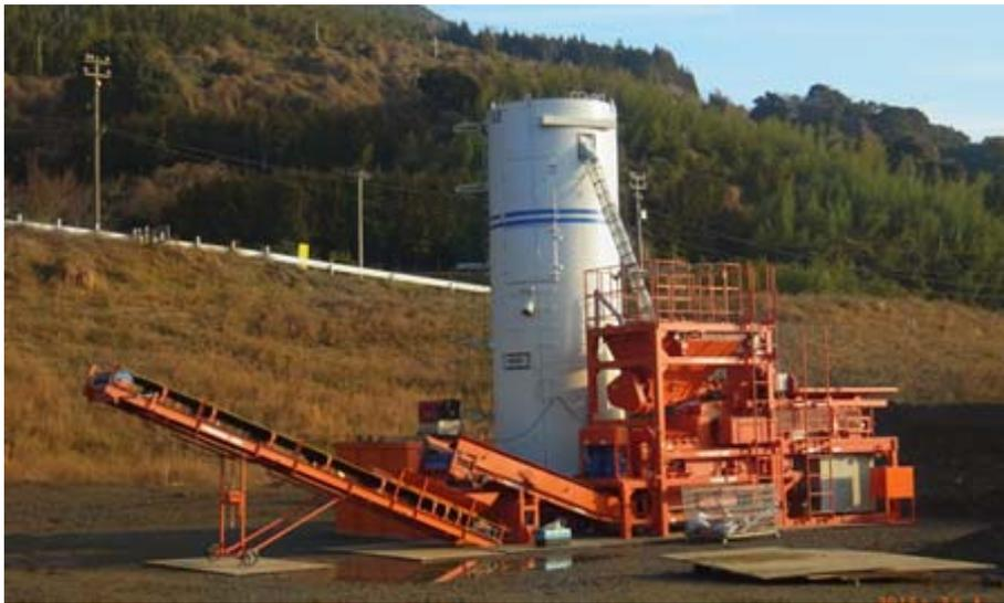
写真- 4.9 セメントサイロを接続した INSEM プラントの例
