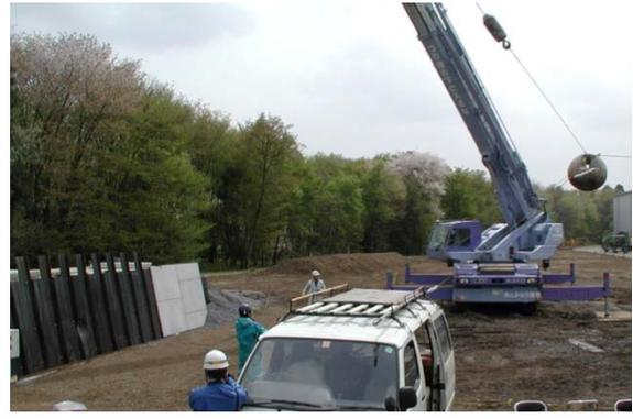
写真- 3.5 衝撃試験状況（振り子方式）
