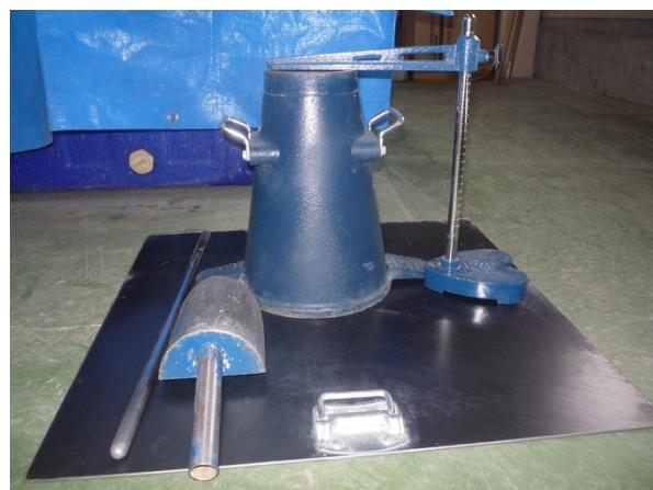
写真- 5.5 コンクリート用スランプ測定機器
