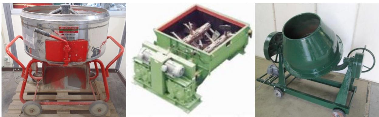
写真- 5.1 室内配合試験で使用する混合機械
