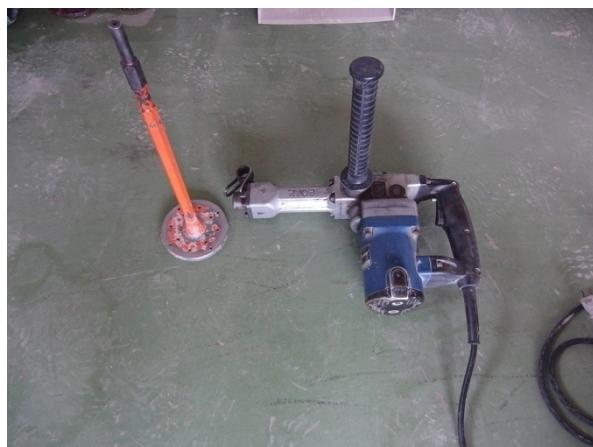
写真- 5.2 締固め器具
