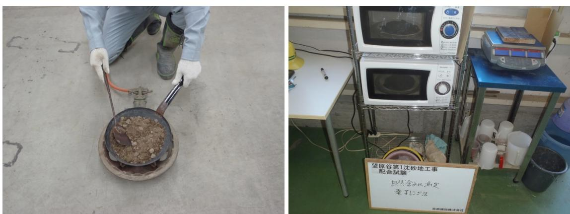
写真- 5.7 含水比測定（左：フライパン法・右：電子レンジ法）
