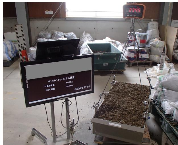
写真- 5.6 試験試料の土砂容積変化率測定状況
