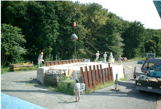
写真- 3.2 衝撃実験状況(自由落下方式)
