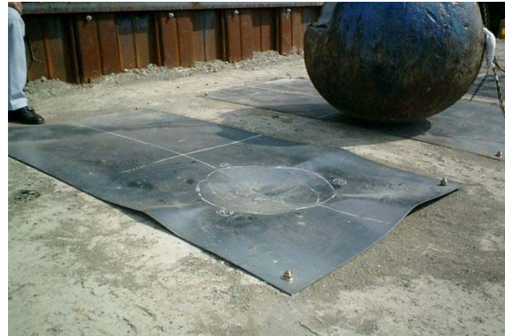
写真- 3.3 衝撃実験後の鋼板の状況
