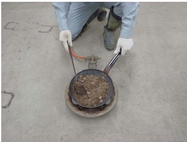
写真- 4.10 含水比測定（左：フライパン法・右：電子レンジ法）
