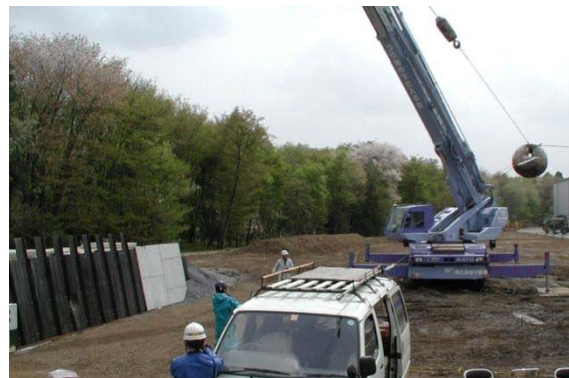
写真- 3.5 衝撃試験状況 (振り子方式)
