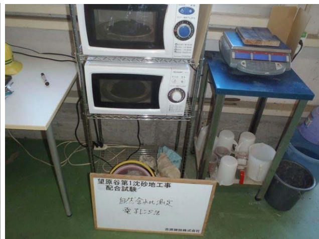
写真- 4.10 含水比測定（左：フライパン法・右：電子レンジ法）
