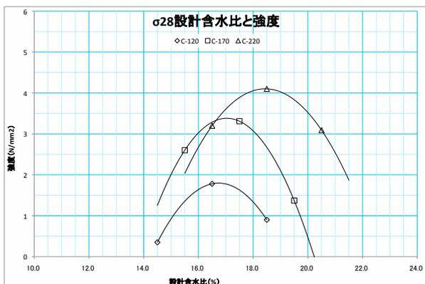
図 3-1 配合試験結果例
