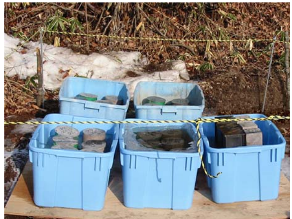
写真- 1 左：空中暴露試験状況、右：水中暴露試験状況
