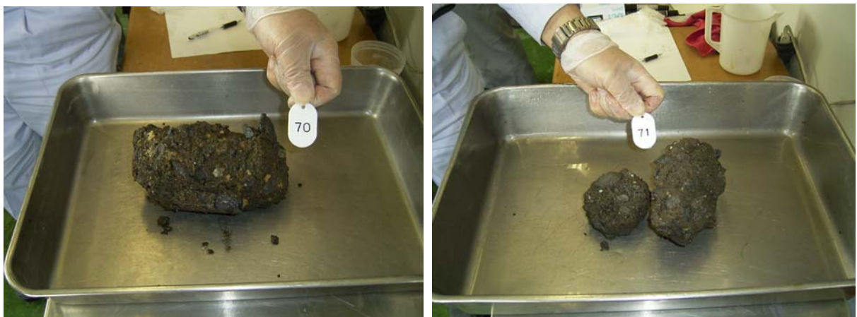
写真- 4 60 サイクル完了後(モールド無)状況 (供試体番号：左 70、右 71)
