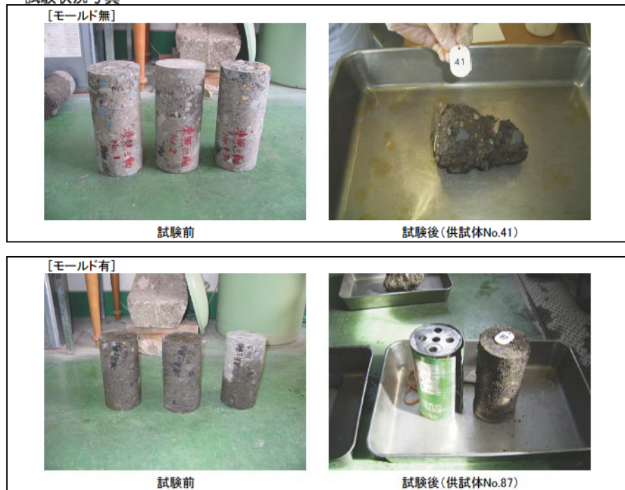
写真- 3 左：試験開始前の供試体（採取コア）状況、右：60 サイクル完了後状況
