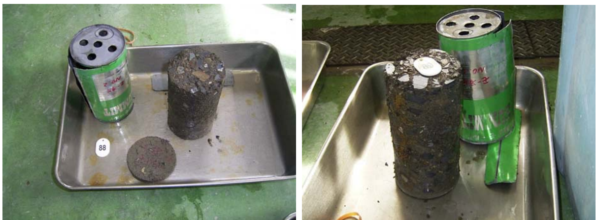
写真- 5 60 サイクル完了後(モールド有)状況 (供試体番号：左 88、右 89)
